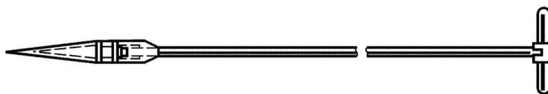
Рисунок А.1 - Щуп автомобильный
