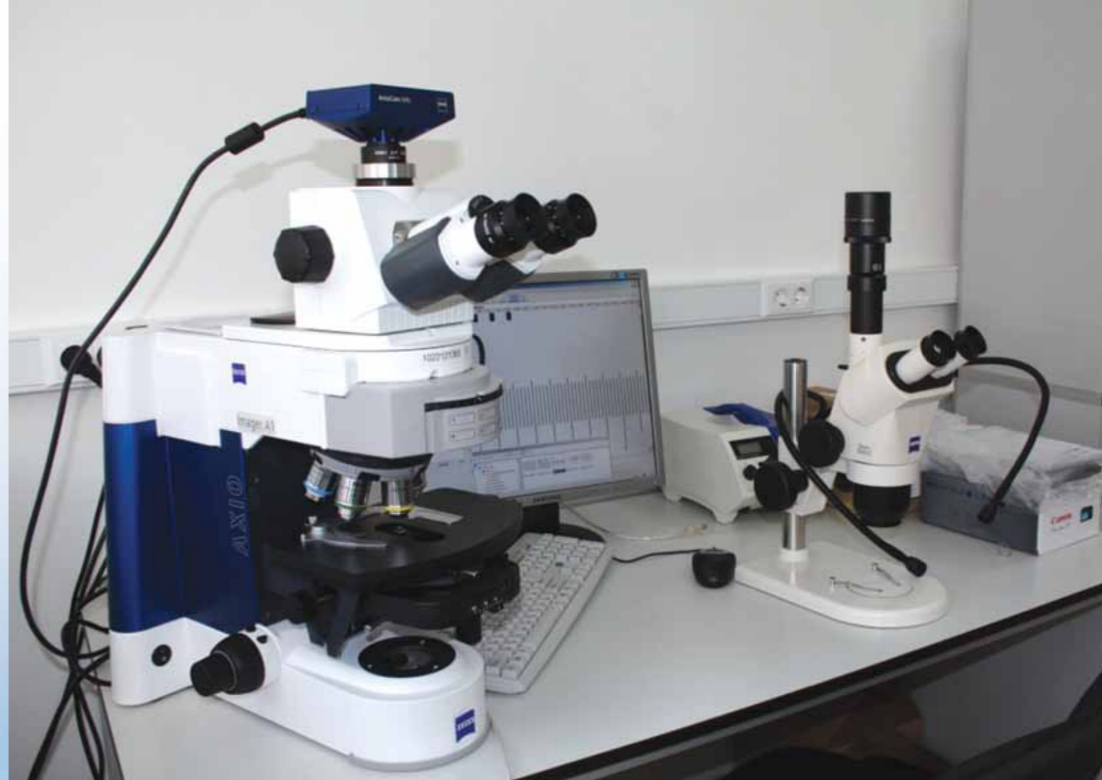
Рис. 2. Новейшая оптика: оптический микроскоп Zeiss Axio Imager A1 и стереоскоп Stemi 2000C (фото Г.Н. Дудченко)
