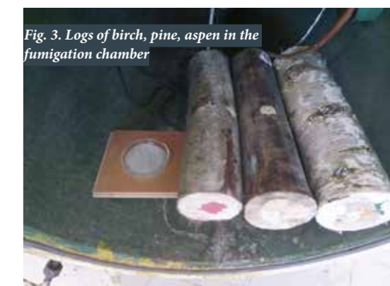
Рис. 3. Бревна березы, сосны, осины в фумигационной камере
