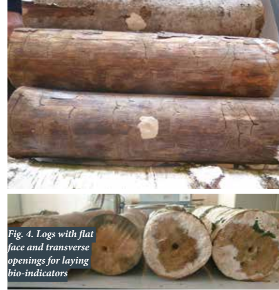
Рис. 4. Бревна с торцевыми и поперечными отверстиями для закладки биоиндикаторов
