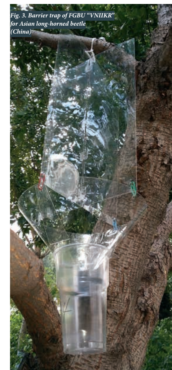
Рис. 3. Барьерная ловушка ФГБУ «ВНИИКР» для азиатского усача (Китай)
