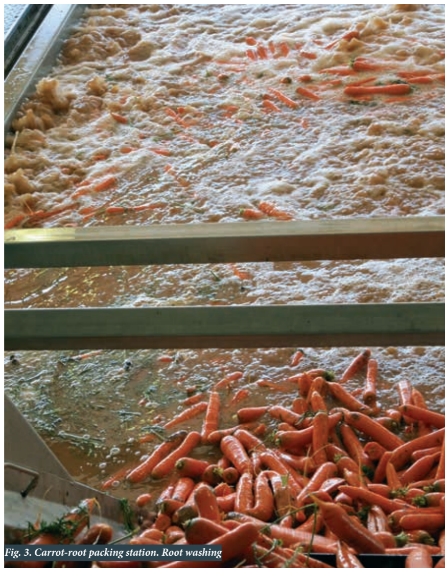
Рис. 3. Упаковочная станция корнеплодов моркови. Мытье корнеплодов
