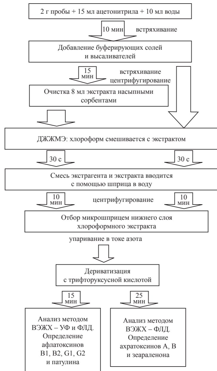
Рис. 2. Общая схема определения восьми микотоксинов в зерне и кормах (продолжительность анализа 1,5–2 ч), при использовании пробоподготовки QuEChERS и ДЖЖМЭ
